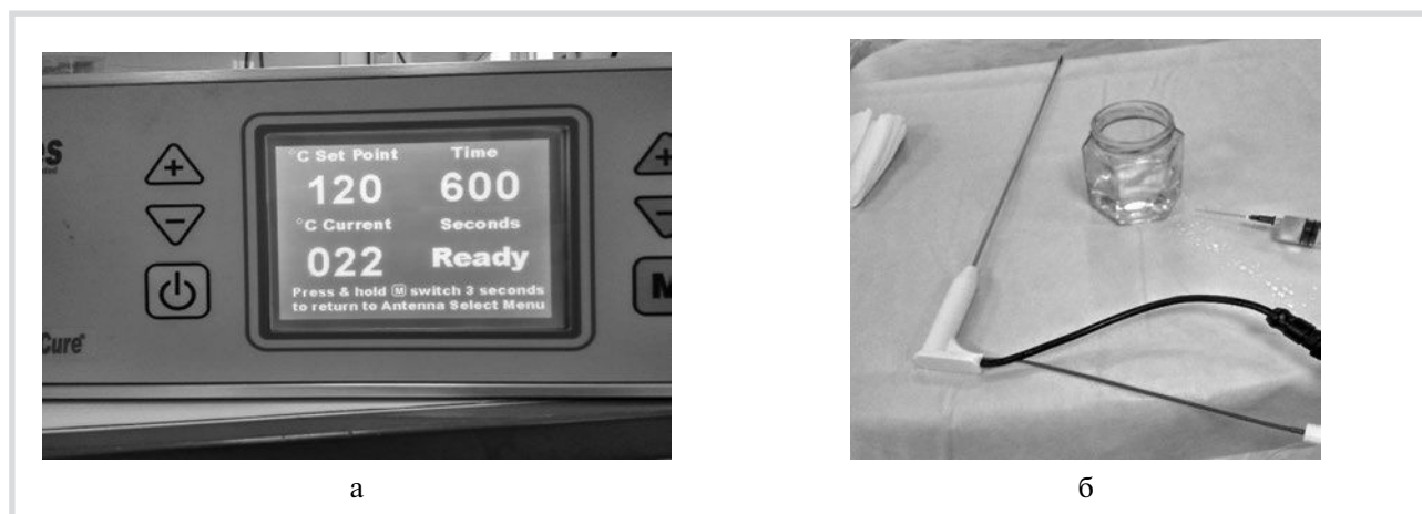
Рис. 1. а — микроволновой аппарат AveCure MWG 881; б — антенна.
